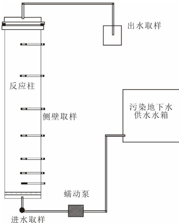
图 5-1 柱实验装置示意图
